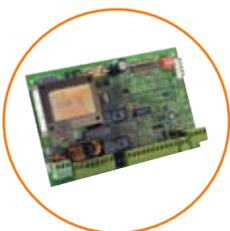
Предназначен для управления двумя приводами с концевыми выключателями с напряжением питания 220В
